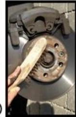
**8** Prüfen ob die Distanzscheibe vollflächig an der Nabenanlagefläche der Felge anliegt.
