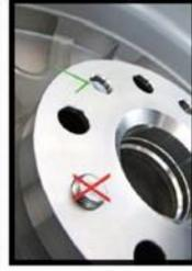
**12B** Befestigungselemente in mindest zwei Durchgängen kreuzweise anziehen. Nur Drehmomentschlüssel auf korrekten Wert einstellen. Siehe dazu die Vorgaben des Fahrzeug- bzw. Felgenreparaturherstellers.
