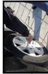
**4** Fahrzeug anheben bis Rad vom Boden abhebt. Unterstellbock unter das Fahrzeug stellen.
